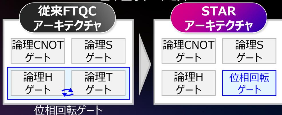
※ 量子ビットを任意の位相角だけ回転させる操作。従来手法では固定角の回転 (T, Hゲート) を何回も繰り返す必要がある。
