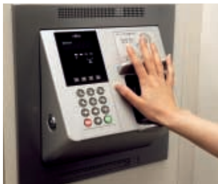
手のひらの静脈で本人識別を行い、入退室を管理します。鍵を使わずに入退室できます。
