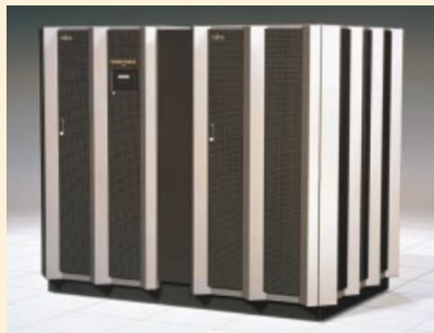
UNIXサーバ PRIMEPOWER2000
