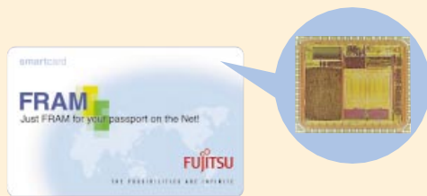
データの読み書きが可能なICチップ（右）を内蔵したICカードのサンプル（左）
