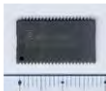
SRAMの置き換えが可能な 不揮発性メモリ 4メガビット FRAM「MB85R4M2T」
