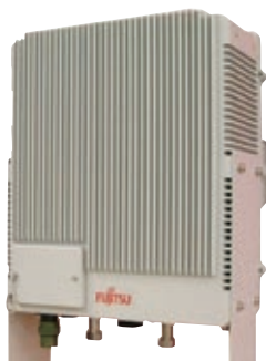
富士通製のLTE向け 携帯電話基地局システム
