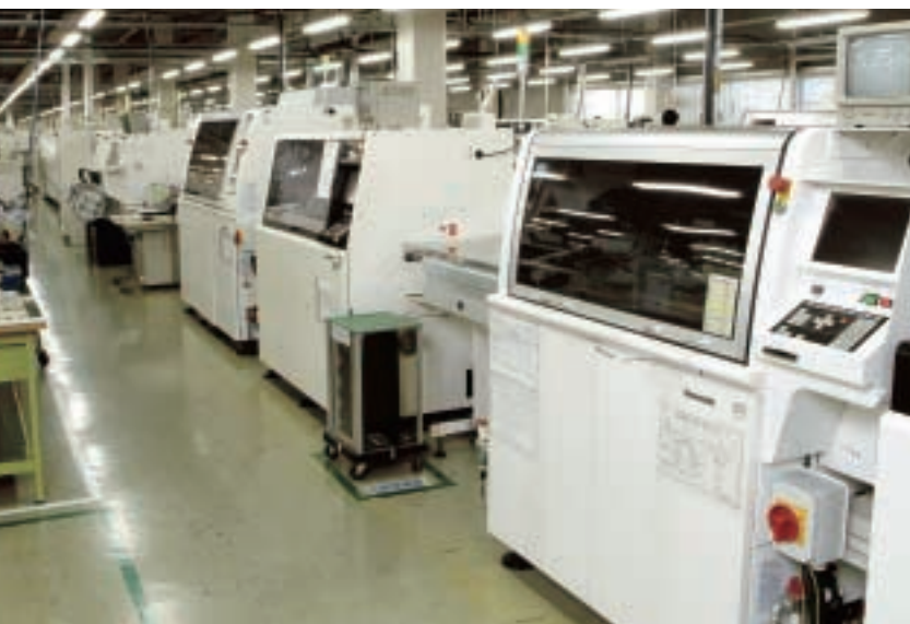
島根富士通工場プリント板自動実装ライン
